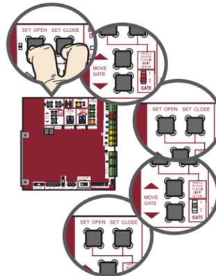
Lorsque les limites sont réglées correctement, l'actionneur sortira automatiquement du mode de réglage des limites.
